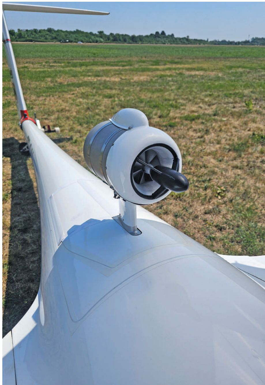
▲ La motorisation jet a une traînée proche de celle du train d'atterrissage.
