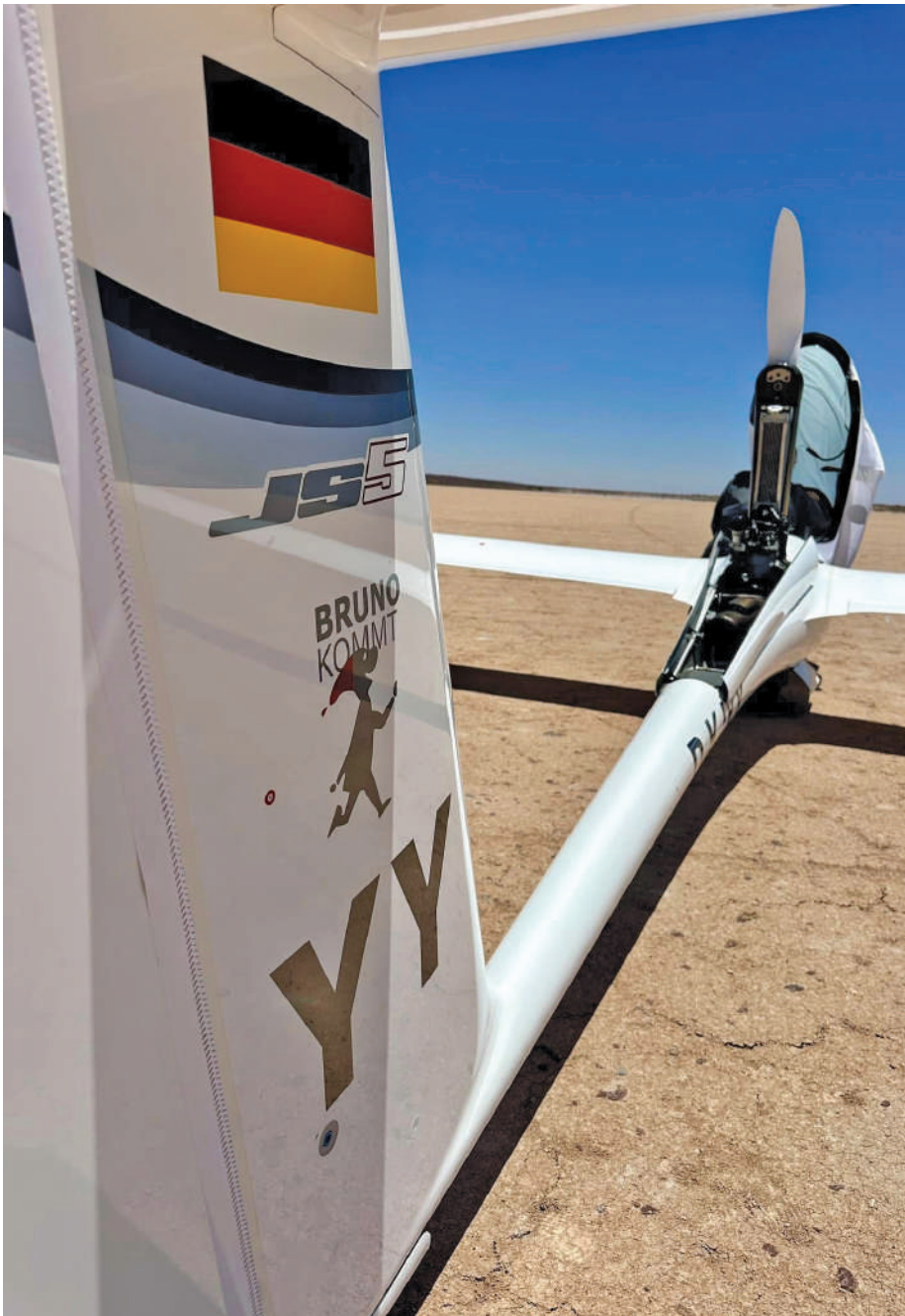
▲ La motorisation thermique Solo permettant un décollage autonome.
