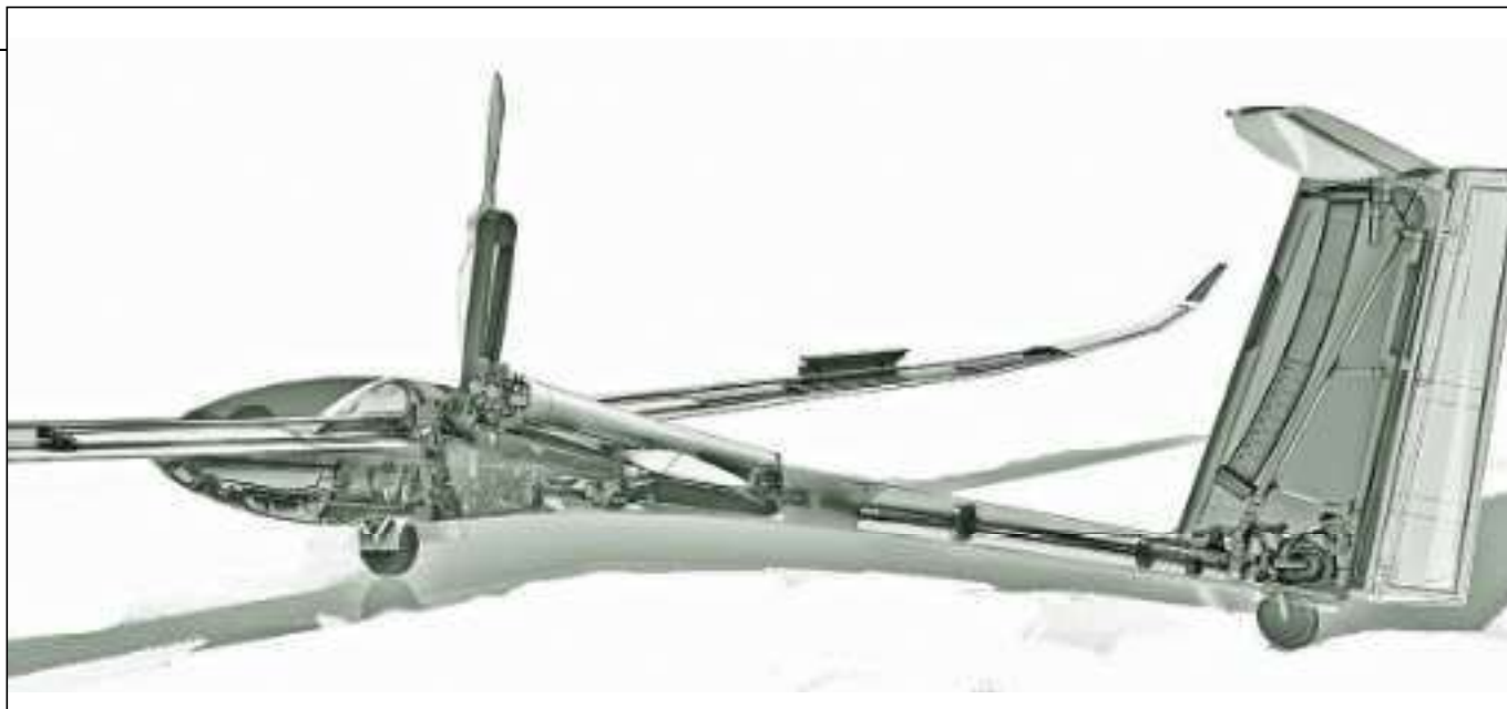
Il JS2 a decollo autonomo, 18/21 metri. In questo disegno, il motore e il ruotino di coda sono rappresentati sia estratti che retratti
