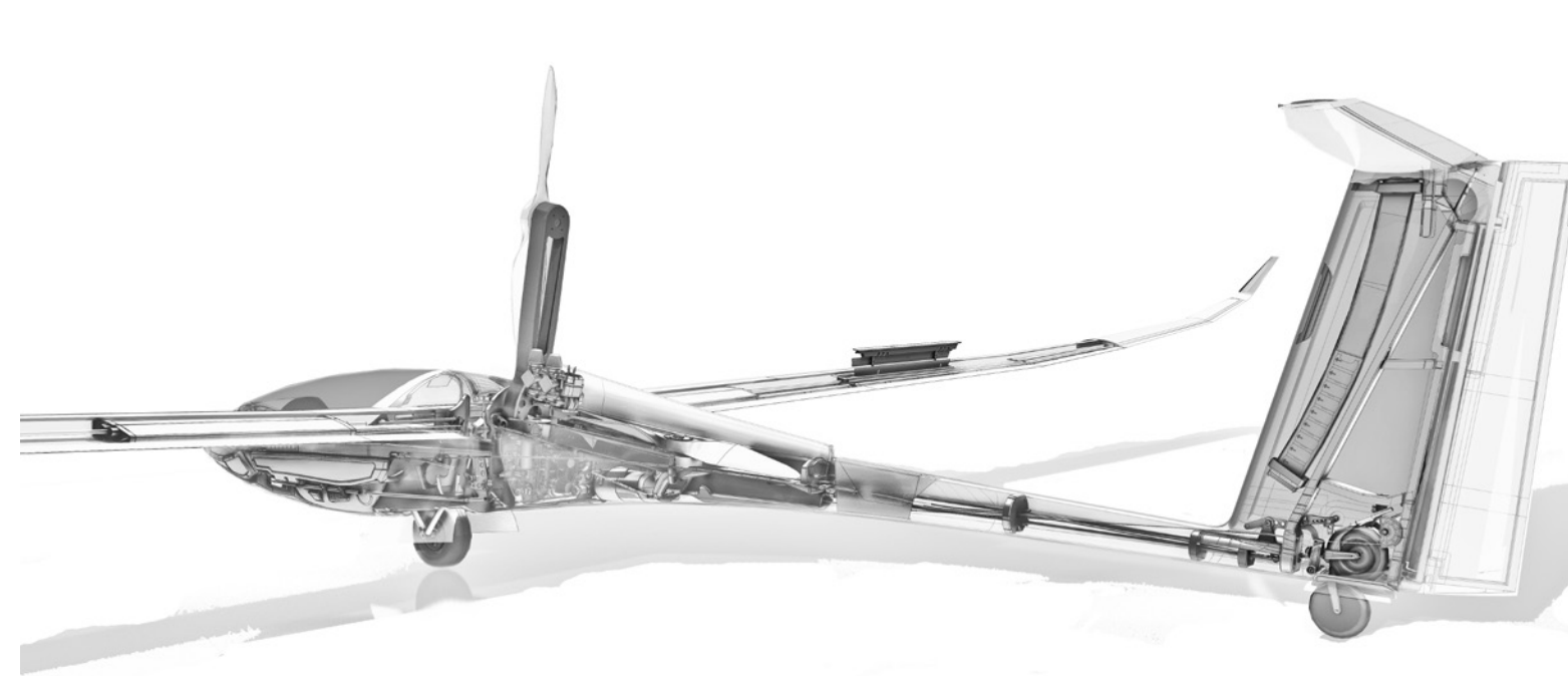
Die JS2 Revenant SL (Selbst Starter) wird mit dem bewährten 68 PS starken SOLO Flugmotor 2625 02i mit Benzineinspritzung und Flüssigkeitskühlung ausgestattet sein
