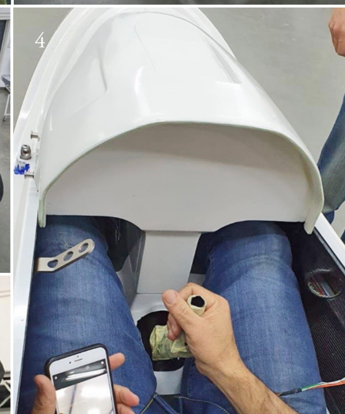
1. Attie Jonker (links) und AP Kotze überprüfen die Position der Einbauteile des JS2-Prototypen anhand der CAD-Modelle. 2. JS2-Rumpfhälften stehen zum Verschließen der Formen bereit. 3. Der JS2-Prototyp frisch ausgeformt. 4. Ein leicht erhöhter Knüppel-Rotationspunkt bietet Platz für Piloten mit größeren Oberschenkeln. 5. Oscar Goudriaan durfte in dem Prototypen schon mal probesitzen und gibt gerne Feedback zur Größe und Ergonomie des Cockpits
